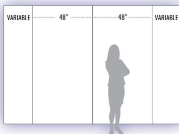
Mur complet, assemblage non-symétrique
